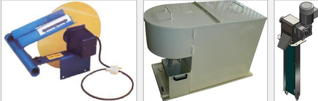
Eine einfache und effiziente Lösung für die Rückgewinnung der in Auffangbehältern von Werkzeugmaschinen schwimmenden Öle und damit zur Erzielung von Einsparungen bei löslichen Ölen.
