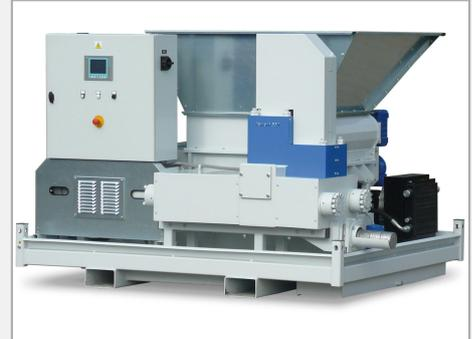
Rückgewinnung von Schneidflüssigkeiten
